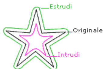
Figura 2. Azione di Intrudi/Estrudi sul tracciato
